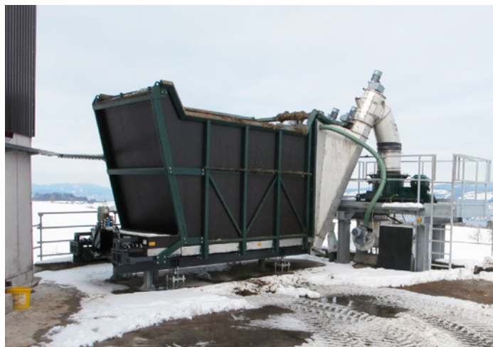
Mit dem Grinder (hier in der Anlage in Wädenswil) werden die Strukturmaterialien sehr fein zerkleinert, um einen besseren Biogasertrag zu erzielen.
